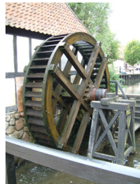
'n Waterwiel gebruik die vloei van die water om die wiel in die rondte te stoot, wat dan die werk kan doen.
